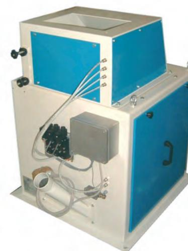
Peseuse électronique à poids net avec alimentation à gravité indiquée pour le dosage de produits granulaires librement coulants.
