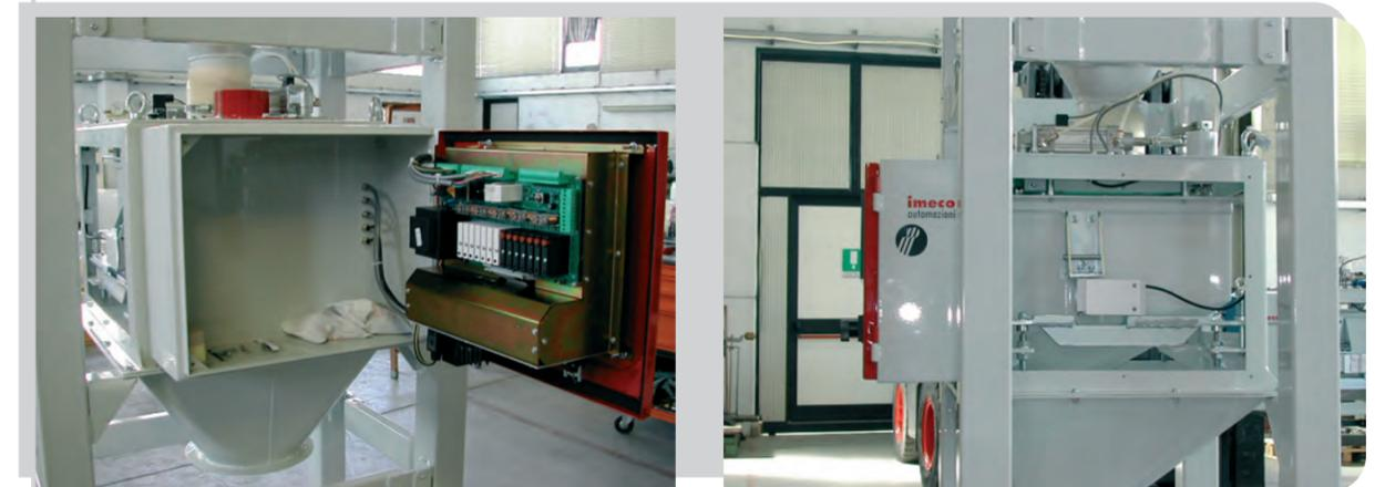
Le projet extrêmement soigné uni à l'utilisation de deux cellules de charge de type OFF CENTER et d'une électronique sophistiquée, garantissent une précision et une fiabilité très élevées.
