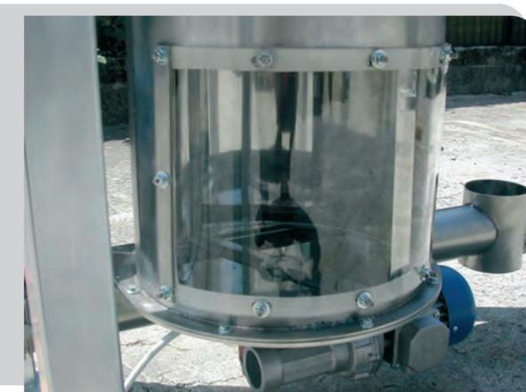
Le produit à l'intérieur de la trémie de pesage est maintenu en mouvement par un agitateur, afin d'éliminer le risque de ponts et d'obstructions. La motorisation pour de la agitateur est indépendante.
