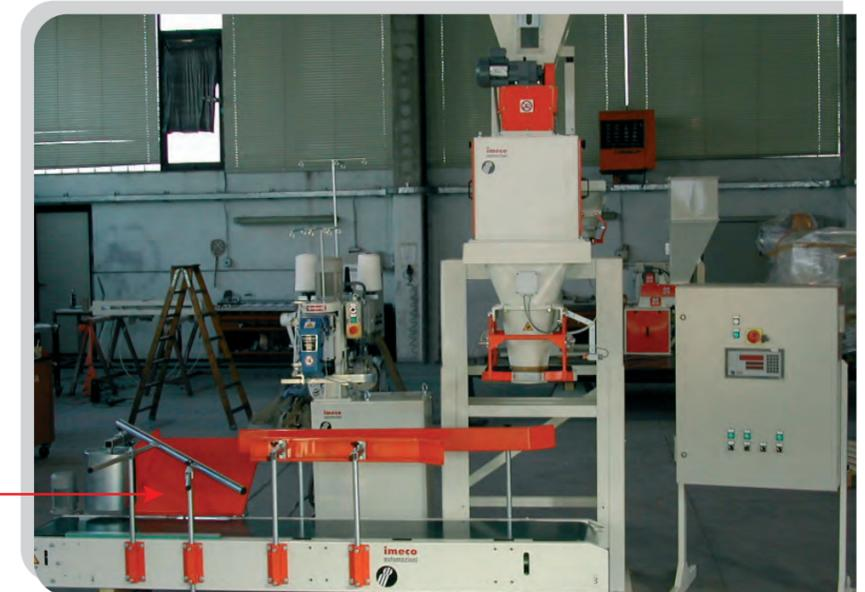
Dispositif pour positionner horizontalement le sac.
