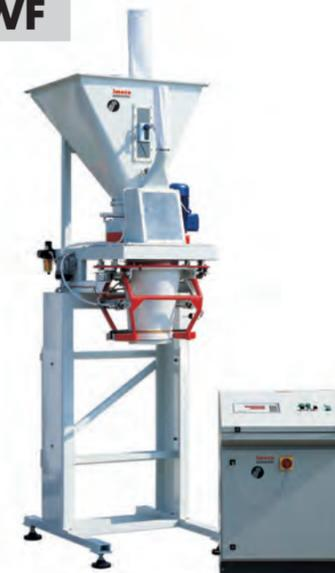
Ensacheuse, peseuse avec alimentation à turbine, indiquée pour le conditionnement de la farine.
