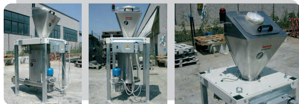
Les différents calibrages diffèrent seulement pour le diamètre de la vis et pour le rapport de la réduction de la motorisation.
