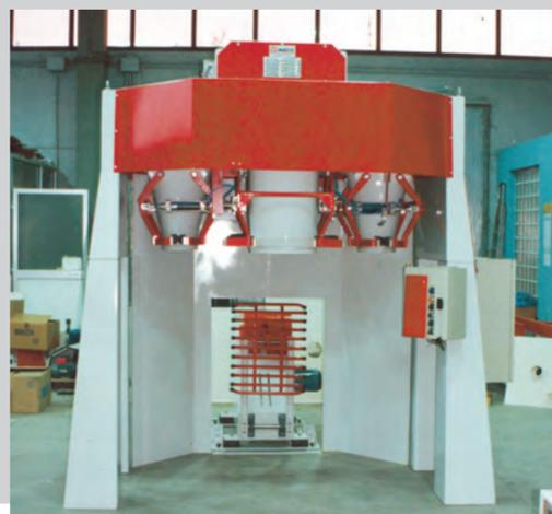
L'ensacheuse à carrousel peut ensacher sacs de 5 à 100 Kg, de plastique, papier, jute, coton, raphie, etc.
