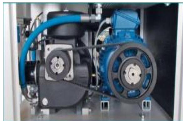
La tension de la courroie s'effectue par le support moteur Basculant. L'amélioration de l'enlacement de la courroie autour de La poulie permet une transmission de puissance optimisée.
